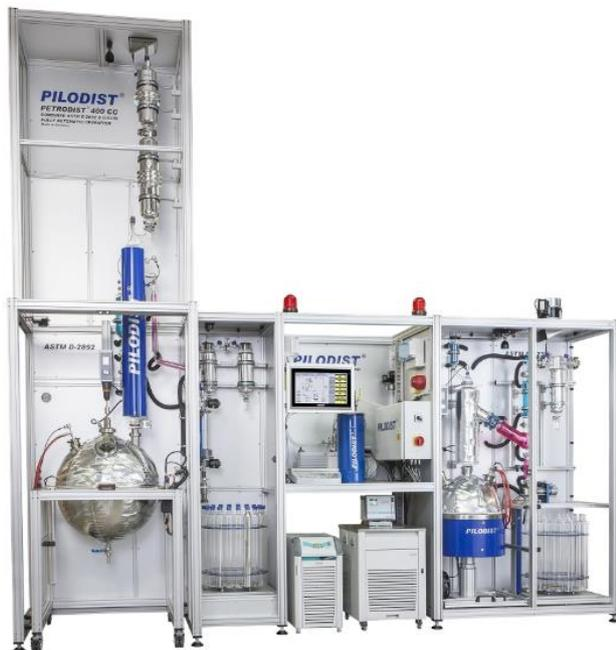
Sistema de destilación de petróleo crudo combinado controlado por procesador para la operación completamente automática de conformidad con ASTM D-2892 (TBP) y ASTM D-5236 (Potstill). PETRODIST 400 CC. Es una combinación de los siguientes sistemas
